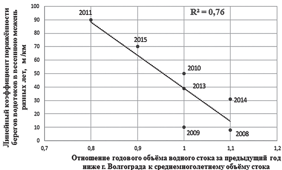
Рис. 4 - Зависимость поражённости берегов водотоков Обжоровского участка заповедника боковой эрозией в весеннюю межень для лет со среднедекадной минимальной отрицательной температурой воздуха полугодового предполоводного периода выше минус 20°С от параметров водного стока предыдущего года
